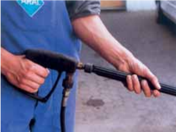
Bild 4 Der sichere Griff: Durch den austretenden Wasserstrahl an der Hochdruckdüse wirkt eine Rückstoßkraft auf die Pistole. Strahlrohr und Pistole des Hochdruckreinigers müssen deshalb gut festgehalten werden.
